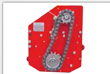
Transmisión lateral de cadena en baño de aceite (modelo "L")
