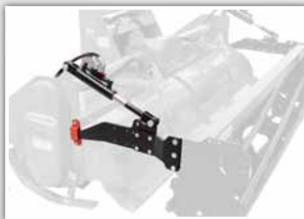
Regulación hidráulica del rodillo
