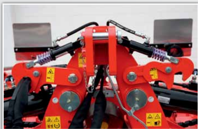
Detalle del sistema de cierre con dispositivo de seguridad automático para el transporte.
