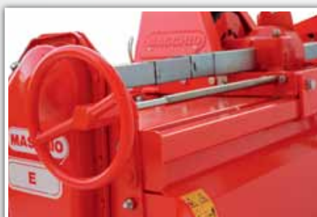
Detalle del sistema de desplazamiento mecánico con tornillo y manivela del modelo "E"
